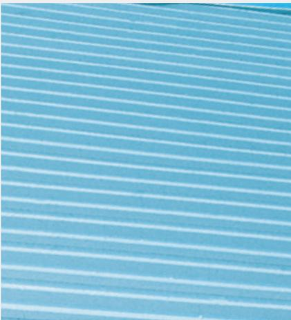
El panel CD 400 es un producto diseñado para ser utilizado como revestimiento, ya que por su sistema de traba, permite una excelente lectura visual. Es posible instalarlo tanto vertical como horizontalmente, tomando en cuenta para esta última aplicación, la instalación de un sello de polietileno reticulado o similar en cada perfil de remate para asegurar su estanqueidad. Debido a su geometría, presenta una excelente resistencia mecánica.
