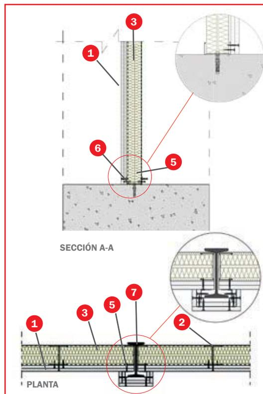
A la hora de hacer el ensayo, por la cara no expuesta al fuego, se montó una chapa galvanizada de 0,6 mm de espesor fijada a los montantes con tornillos rosca-chapa de 13 mm. Esta chapa no ofrece resistencia al fuego, por lo que en el montaje real puede ser sustituida.
