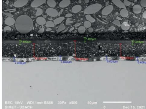
**Figura C.1** Imagen a 500 aumentos, **Muestra 15597-01: "Plancha verde perlado"**.
