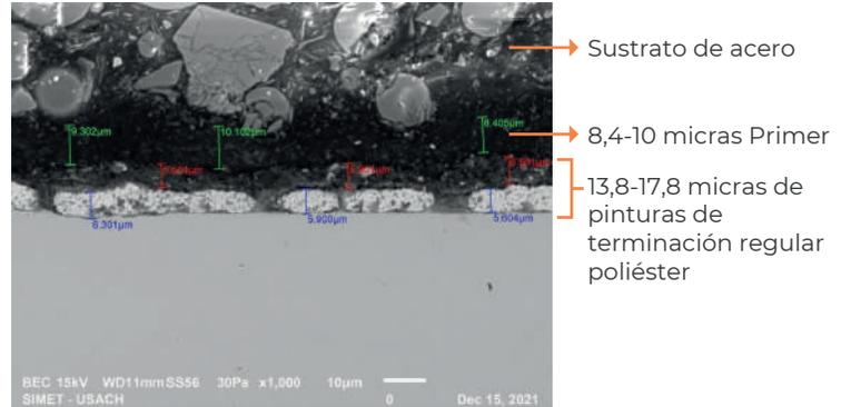
**Figura C.2** Imagen a 1.000 aumentos, **Muestra 15597-02: “Plancha verde texturado”**.
