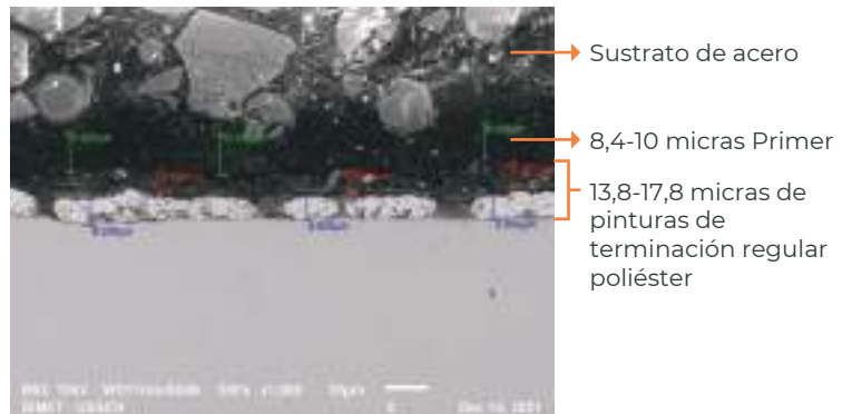
Figura C.2 Imagen a 1.000 aumentos, Muestra 15597-02: "Plancha verde texturado" .
