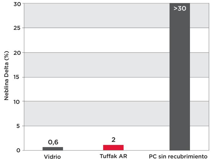
\*Abrasión Taber según ASTM D 1044, 100 ciclos, usando rueda CS-10F en 500 g de carga
