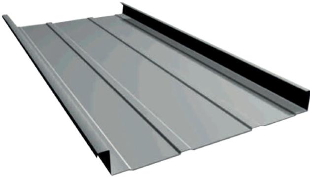
Las planchas se unen por traslape de nervios entre ganchos de fijación oculta y a través de un sistema emballetado a 90° (un pliegue) y 180° (dos pliegues).
