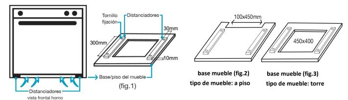
Además, el horno debe estar apoyado en una superficie plana con una abertura de al menos 100x450mm en la parte trasera (fig.2), o bien una perforación en el centro de 450x400mm (fig.3) dependiendo de la naturaleza de su mueble.
