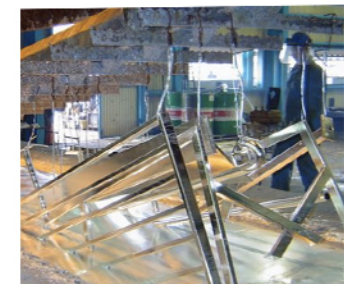
Galvanizado en inmersión con electrolisis
