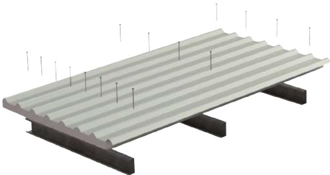
**1.** El panel se puede instalar idealmente sobre costaneras (aumentando su distanciamiento con la intención de reducir la cantidad de elementos estructurales). A su vez, se puede instalar sobre tabiques estructurales o de paneles del mismo producto.
