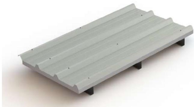
Una vez posicionado el panel en la estructura, este debe ser atornillado con tornillos de cabeza hexagonal del largo adecuado para superar el espesor del panel por al menos 2 pulgadas en estructuras de madera y una pulgada en estructuras metálicas.
